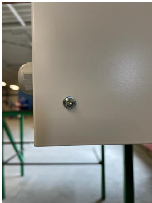
Figuur 33: Bevestiging van bout in zijkant onderkap.
