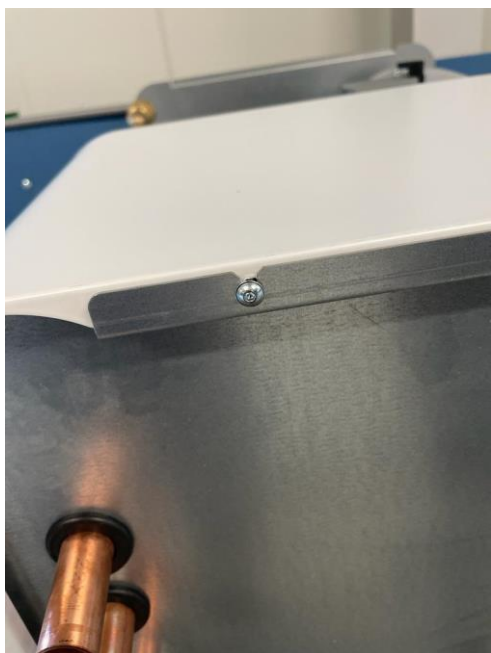
Figuur 32: Bevestiging van bout in onderkant van de onderkap.
